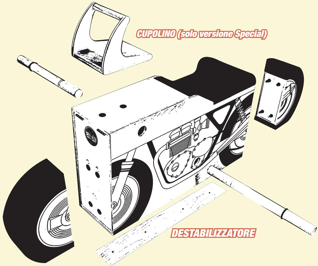
*Le barre in legno vanno fissate con gli appositi o-ring in gomma per evitare che escano dalla sede durante l'utilizzo. Le ruote ed il cupolino sono dotati di attacchi rapidi adeguati all'utilizzo da parte di un bambino, inoltre favoriscono lo smontaggio rapido degli elementi che, riposti all'interno, negli appositi spazi, riducono notevolmente l'ingombro del giocattolo. Nel caso si preferisca fissare le parti mobili è possibile farlo utilizzando le viti in dotazione.*
